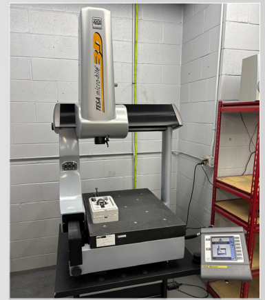
TESA MICRO-HITE 3-D CMM MODEL TESA SA
