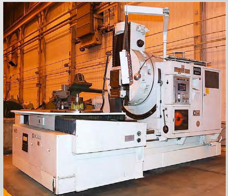
MAAG SH250 LARGE CAPACITY GEAR SHAPER
