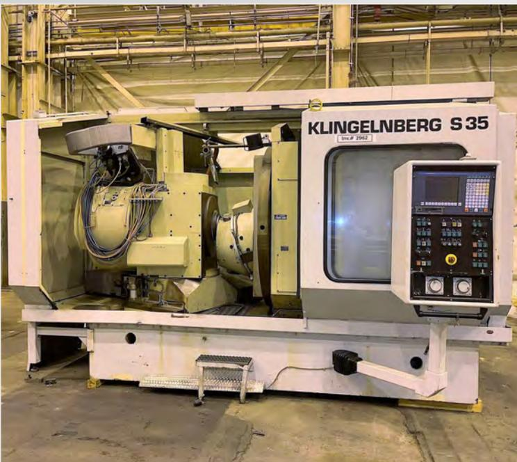
KLINGELNBERG S-35 10-AXIS CNC GEAR CUTTING MACHINE
