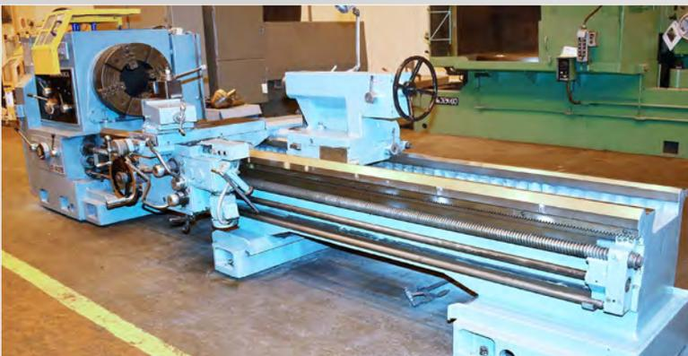
**KURAKI LC403 HOLLOW SPINDLE LATHE**
