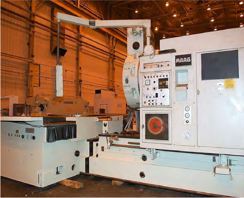
MAAG SH450/500S LARGE CAPACITY GEAR SHAPER
