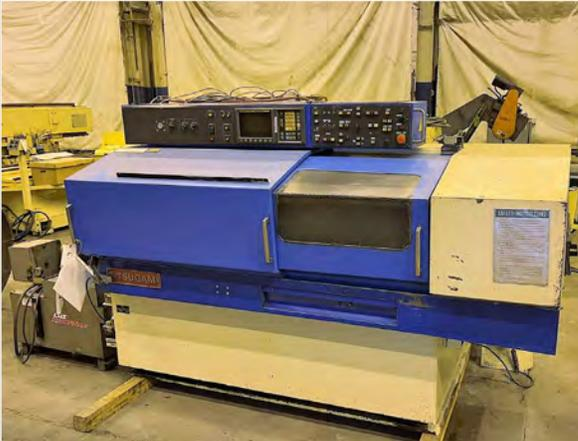
**TSUGAMI NP-32 CNC SWISS-TYPE CNC TURNING CENTER**
