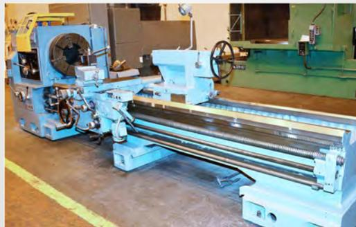
KURAKI LC403 HOLLOW SPINDLE LATHE
