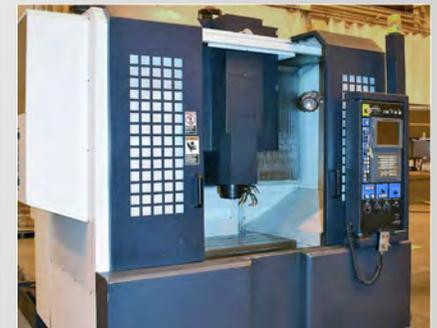
MAKINO S33 CNC HIGH SPEED VMC
