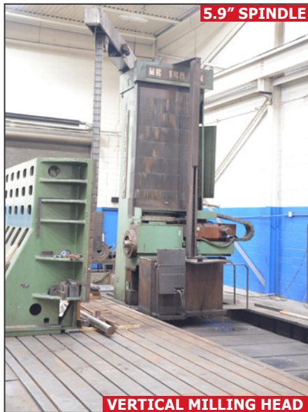
G. LAZZATI & CO. HB 150 MM floor-type horizontal boring mill
