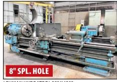
LEHMAN HYDRATROL 28" X 120" HOLLOW SPINDLE LATHE
