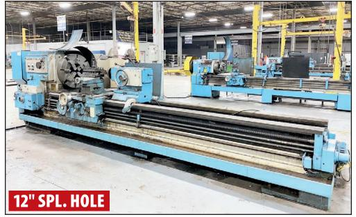
LODGE & SHIPLEY 2XE3220 40" X 144" HOLLOW SPINDLE LATHE
