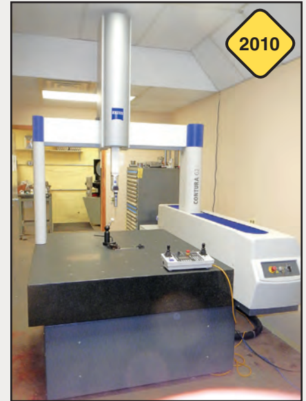
2010 ZEISS CONTURA G2 10/12/G RDS CMM
