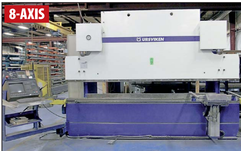
PULLMAX/URSVIKEN OPTIMA 130 4.1 3.15 8-AXIS CNC PRESS BRAKE
